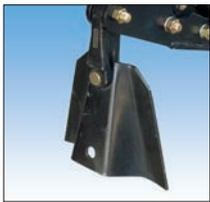
下層の硬盤や圧密層を破碎して膨軟にします。追従式なので貫入時や引き上げ時に圃場に大きな穴を開けません。
