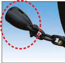
破碎と同時に水みちの穴を空け、簡易暗渠で透・排水性を促進します。
