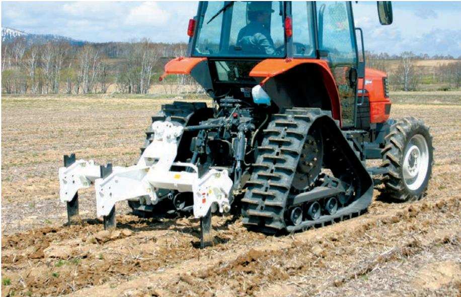
サブソイラナイフを土中に貫入し進行させることにより、下層部に形成される硬盤層(不透水層)に亀裂を入れたり、固結した心土を破碎・膨軟にし、透・排水性を向上させます。
